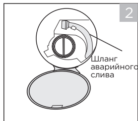
Выньте шланг аварийного слива, вытащите заглушку
