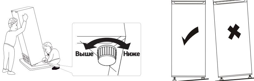
Отклоните холодильник назад на 10 мм или 0,5°, сделав 1-2 дополнительных оборота регулируемых ножек. Это позволит дверям холодильника возвращаться в закрытое положение.
